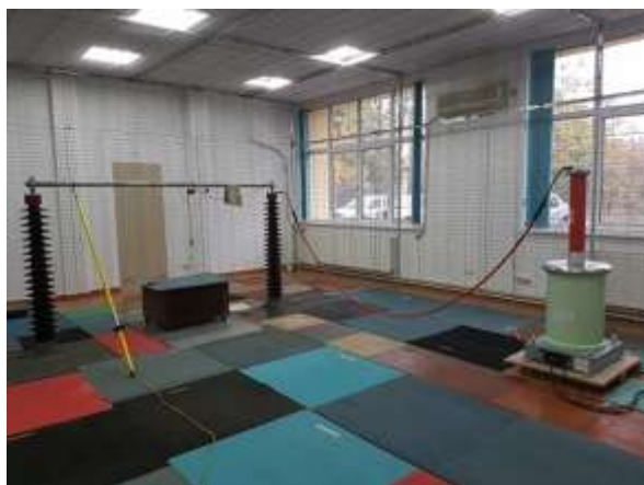
Fig.6.4 Standul de încercări cu tensiune mărită
