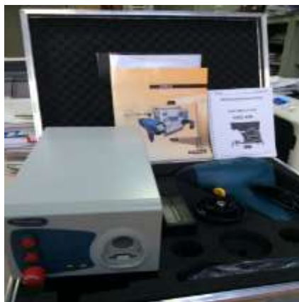
Fig.19. Aparat de determinare a încărcării electrostatice Schaeffer tip NSG 438. Modul de simulare efectelor de interferență electromagnetică
