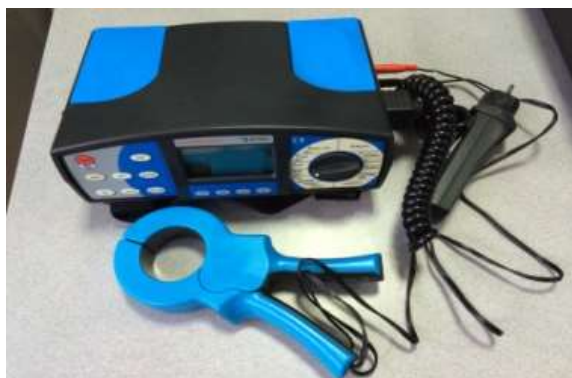
Fig.21. Aparat pentru măsurarea rezistență izolație, iluminare tip EUROTTEST 61557
