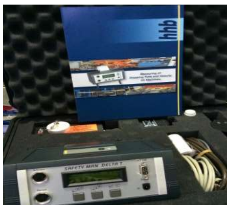
Fig.18. Echipament de evaluare a timpului de oprire, vitezei de oprire și a distanțelor de securitate la mașinile care prezintă pericole- Safety Man Delta T 4/2001
