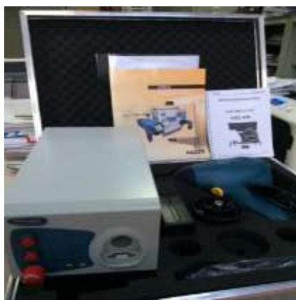
Fig.9. Aparat de determinare a încărcării electrostatice Schaeffer tip NSG 438. Modul de simulare efectelor de interferență electromagnetică
