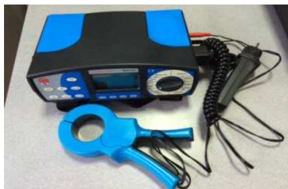
Fig.11 Aparat pentru măsurarea rezistență izolație, iluminare tip EUROTTEST 61557
