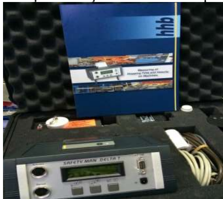
Fig.8. Echipament de evaluare a timpului de oprire, vitezei de oprire și a distanțelor de securitate la mașinile care prezintă pericole- Safety Man Delta T 4/2001
