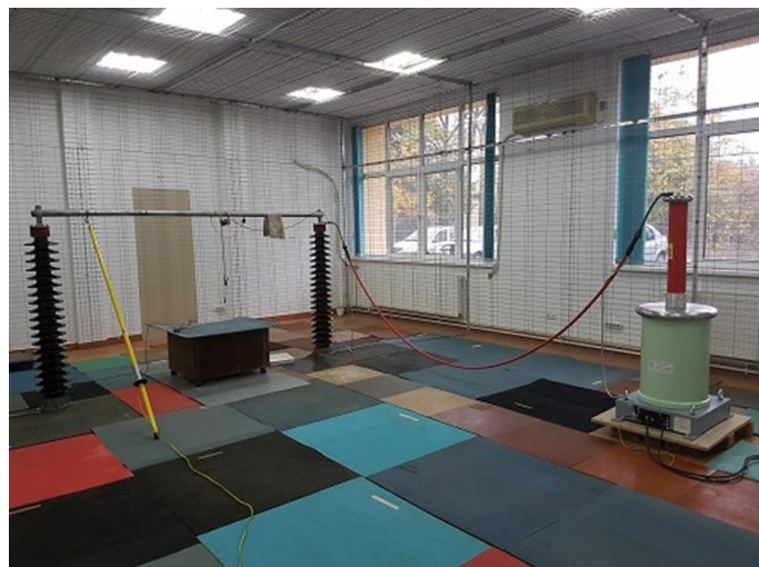
Fig.16 Standul de încercări cu tensiune mărită
