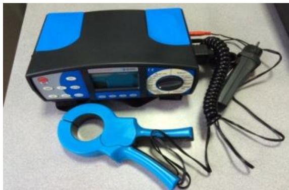
Fig.12 Aparat pentru măsurarea rezistență izolație, iluminare tip EUROTEST 61557
