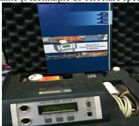
Fig.9. Echipament de evaluare a timpului de oprire, vitezei de oprire și a distanțelor de securitate la mașinile care prezintă pericole- Safety Man Delta T 4/2001
