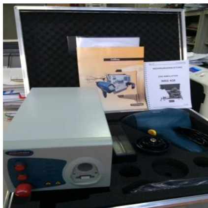
Fig.10. Aparat de determinare a încărcării electrostatice Schaeffer tip NSG 438. Modul de simulare efectelor de interferență electromagnetică
