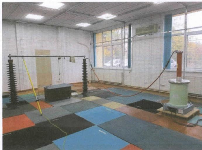
Fig.5 Standul de încercări cu tensiune mărită
