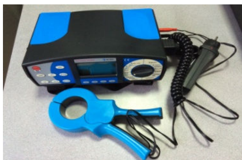
Fig.16. Aparat pentru măsurarea rezistență izolație, iluminare tip EUROTEST 61557
