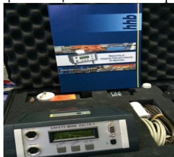
Fig.13. Echipament de evaluare a timpului de oprire, vitezei de oprire și a distanțelor de securitate la mașinile care prezintă pericole- Safety Man Delta T 4/2001
