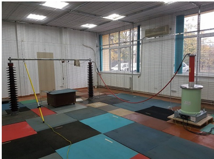
Fig.9 Standul de încercări cu tensiune mărită
