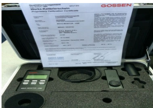
Fig.15. Luminanțmetru tip MAVO-Monitor- USB Gossen
