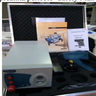
Fig.14. Aparat de determinare a încărcării electrostatice Schaeffer tip NSG 438.Modul de simulare efectelor de interferență electromagnetică
