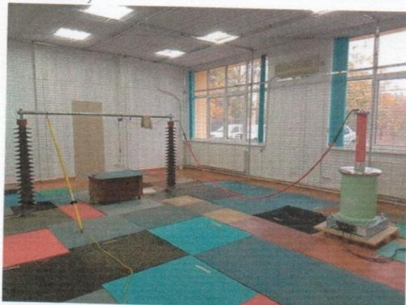
Fig.9 Standul de încercări cu tensiune mărită
