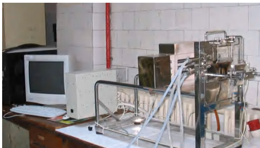
Fig.33 Aparatura de încercare pentru determinarea rezistenței la căldură radiantă
