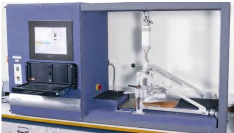
Fig.31 Aparatura de încercare pentru determinarea rezistenței la alunecare
