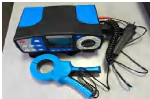
Fig.52. Aparat pentru măsurarea rezistență izolație, iluminare tip EUROTTEST 61557
