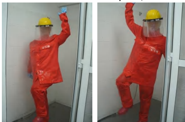
Fig.30 – Fază de încercare – stropire pentru determinarea rezistenței la penetrarea ceții (încercare la ceață) a îmbrăcăminte de protecție împotriva substanțelor chimice
