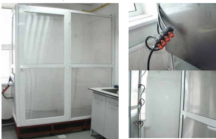
Fig.29 – Cabină cu instalația privind determinarea rezistenței la penetrarea ceții (încercare la ceață) a îmbrăcăminte de protecție
