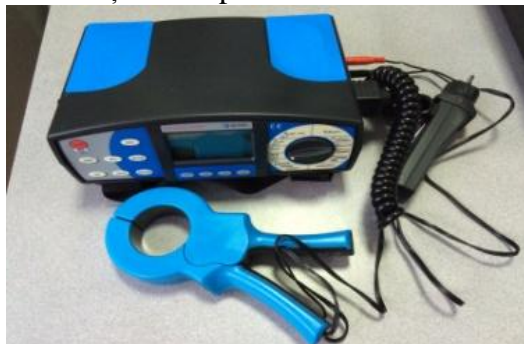
Fig.63. Aparat pentru măsurarea rezistență izolație, iluminare tip EUROTTEST 61557
