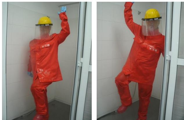
Fig.40 – Fază de încercare - stropire pentru determinarea rezistenței la penetrarea ceței (încercare la ceață) a îmbrăcăminte de protecție împotriva substanțelor chimice
