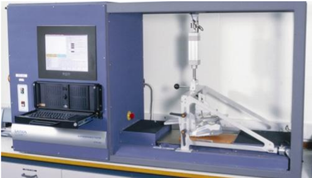
Fig.41 Aparatura de încercare pentru determinarea rezistenței la alunecare
