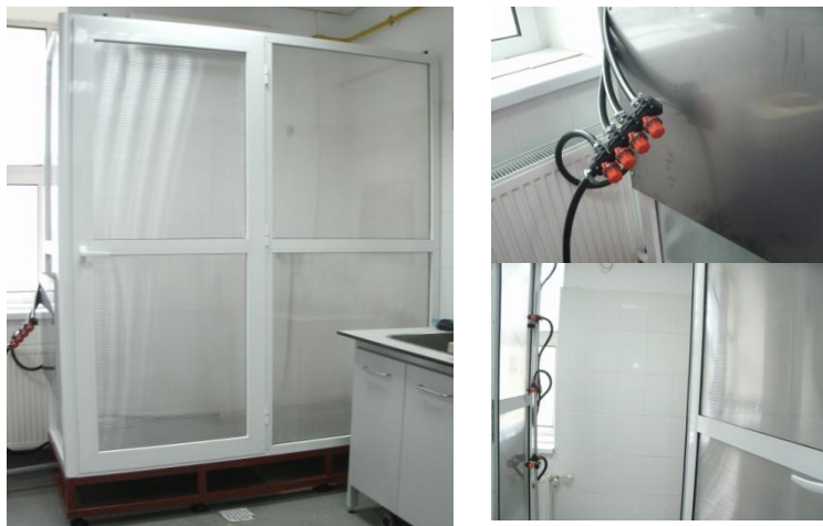
Fig.39 – Cabină cu instalația privind determinarea rezistenței la penetrarea ceței (încercare la ceață) a îmbrăcăminte de protecție
