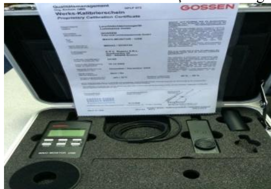
Fig.62. Luminanțmetru tip MAVO-Monitor- USB Gossen
