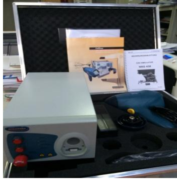
Fig.61. Aparat de determinare a încărcării electrostatice Schaeffer tip NSG 438. Modul de simulare efectelor de interferență electromagnetică
