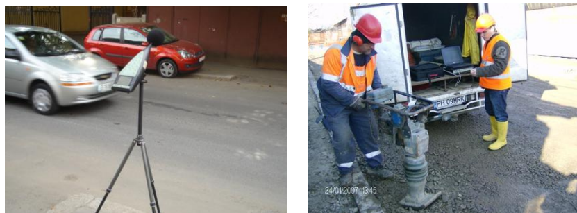
Fig. 18 Măsurarea nivelului de zgomot și vibrații în exterior
