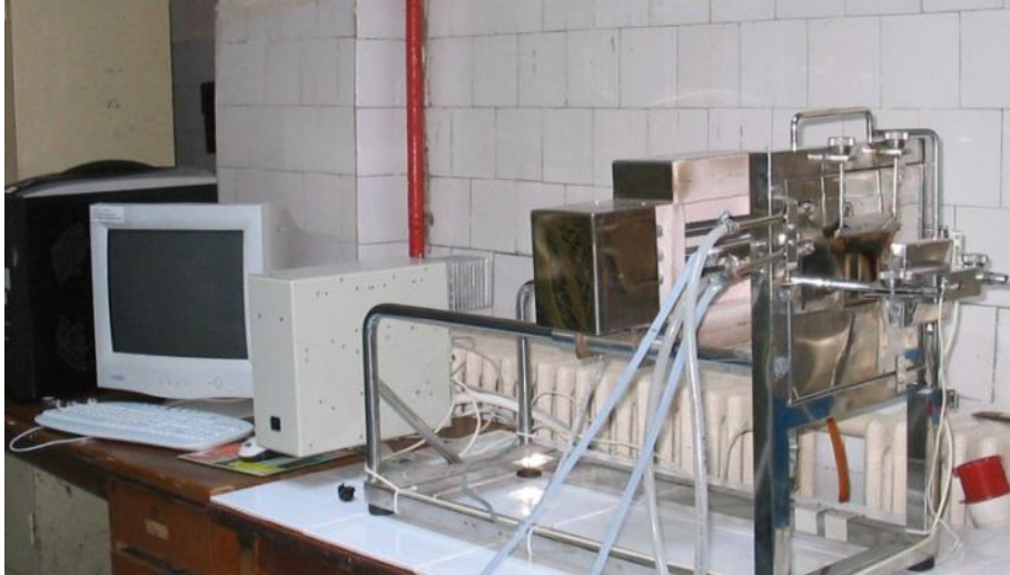
Fig.43 Aparatura de încercare pentru determinarea rezistenței la căldură radiantă
