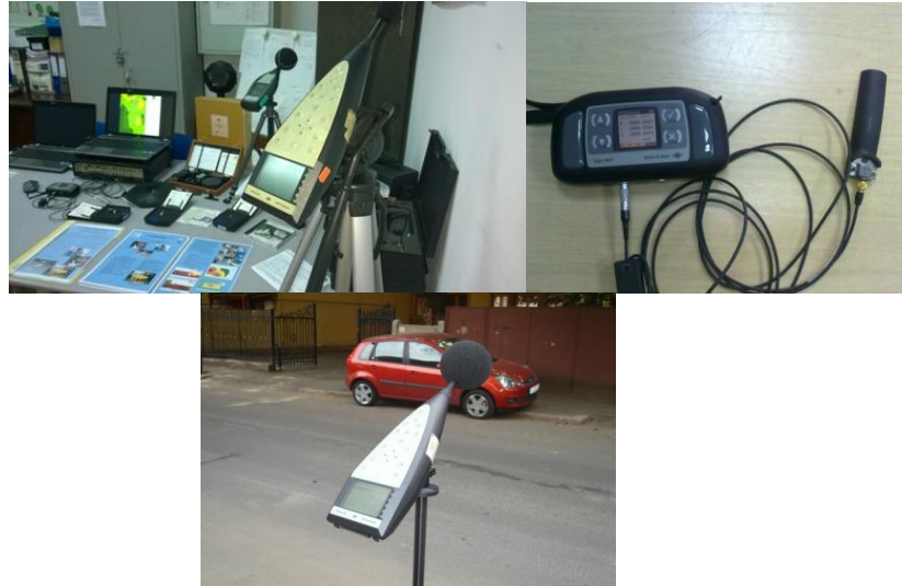
Fig. 24 Aparatura de masurare a zgomotului si vibratiilor din dotarea laboratorului
