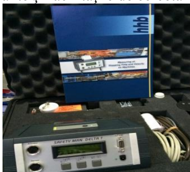
Fig.60. Echipament de evaluare a timpului de oprire, vitezei de oprire și a distanțelor de securitate la mașinile care prezintă pericole- Safety Man Delta T 4/2001
