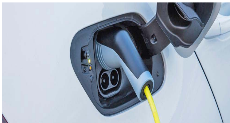
Figura nr. 15 – vehicul electric cu priza tip COMBO
