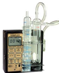
Figura nr. 2.1.2 Pompa universală de prelevare cu debite mici cu impinger
