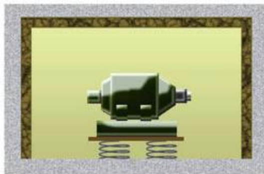
Figura nr.6. Izolarea echipamentului zgomotos într-o incintă tratată acustic 22
