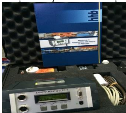
Fig.10. Echipament de evaluare a timpului de oprire, vitezei de oprire și a distanțelor de securitate la mașinile care prezintă pericole- Safety Man Delta T 4/2001
