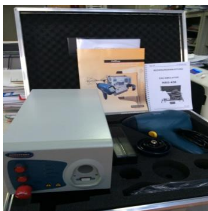
Fig.11. Aparat de determinare a încărcării electrostatice Schaeffer tip NSG 438. Modul de simulare efectelor de interferență electromagnetică
